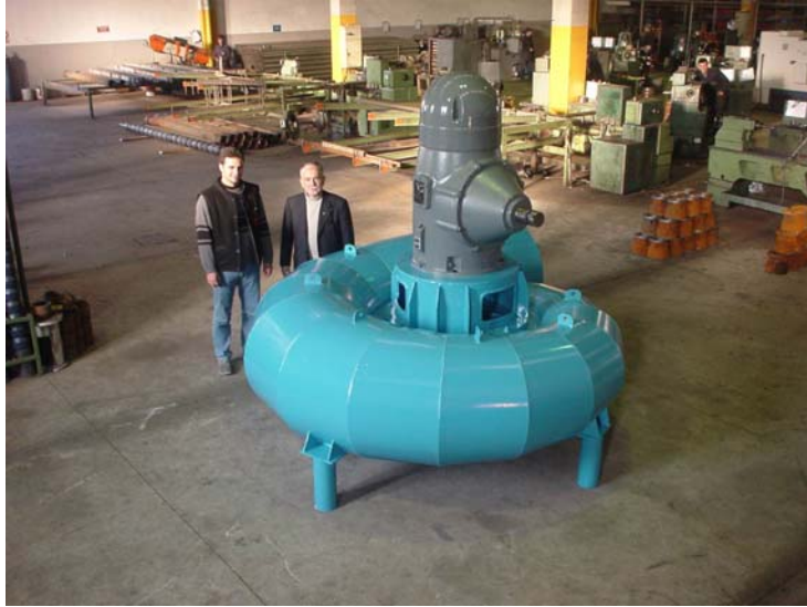
Şekil17. Yerine montaja hazır hale getirilmiş türbin-redüktör.
