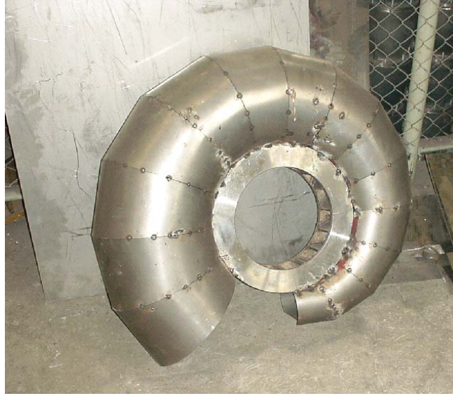
Şekil 14. 1/3 ölçekte saçtan prototip salyangoz hazırlanması.
